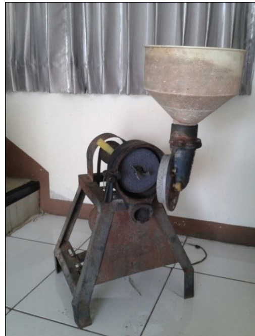
รูปที่ 1 เครื่องที่ใช้หินในการบดทำให้เม็ดถั่วเหลืองละเอียด
