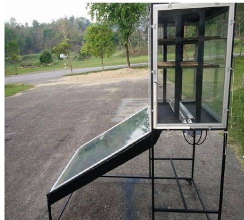
รูปที่ 5 ตู้อบแห้งพลังงานแสงอาทิตย์แบบโดยอ้อม
