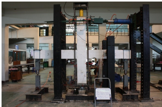
รูปที่ 6 การติดตั้งตัวอย่างทดสอบในห้องปฏิบัติการ
