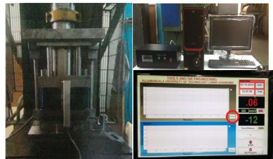
รูปที่ 4 การติดตั้งชุดแม่พิมพ์ลากขึ้นรูปและอุปกรณ์วัดแรงกับวัดระยะทาง บนเครื่องเพรสไฮดรอลิก
