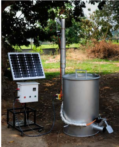
รูปที่ 6 เตาเผาแบบกลบความร้อนสูงด้วยไฟฟ้าพลังงาน แสงอาทิตย์และชุดแหล่งจ่าย
