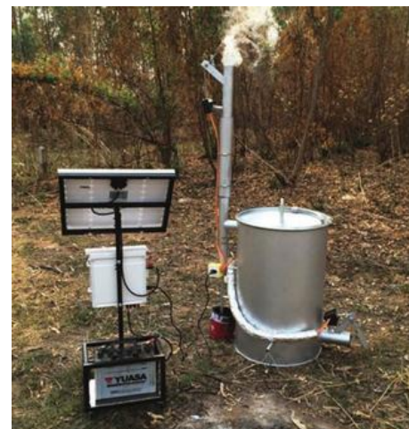
รูปที่ 8 การทดลองการเผาเตาเผาแบบคุณภาพสูงด้วยเตา ความร้อนสูงแบบมีระบบปิดอัตโนมัติ
