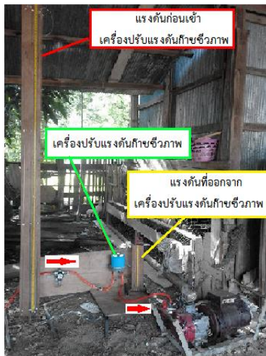
รูปที่ 4 การทดสอบเครื่องปรับความดันก๊าซชีวภาพ
