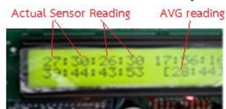
รูปที่ 17 ค่าที่อ่านได้จาก Sensor 4 ตัวและค่าเฉลี่ย
