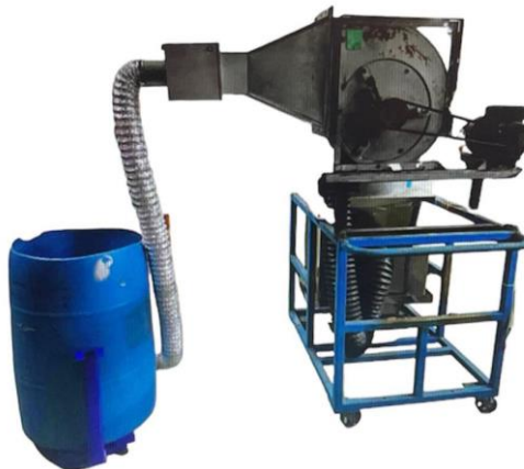
รูปที่ 1 ชุดระบบควบคุมการระบายอากาศแบบอัตโนมัติในภาชนะเก็บข้าวเปลือก
