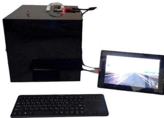
รูปที่ 7 แสดงการเชื่อมต่อของระบบเครื่องมือที่ใช้ถ่ายภาพตลอดเลียดำโดยใช้แสงใกล้อินฟราเรด
