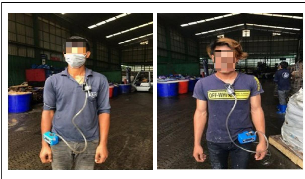
ภาพที่ 3 การเก็บตัวอย่างก่อนและหลังปรับปรุงระบบระบายอากาศเฉพาะที่ตามแบบวิธี NIOSH 0600, อนุภาคขนาดเล็กที่อาจสูดเข้าสู่ระบบทางเดินหายใจได้ (Respirable Dust) พนักงานแผนกทอดอาหารปลา
