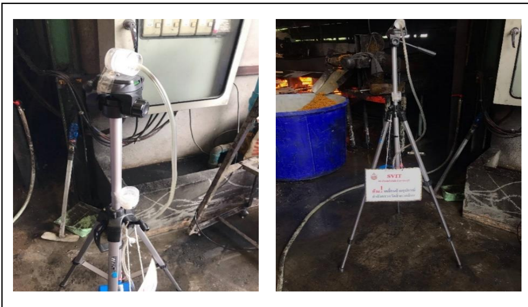
ภาพที่ 2 การเก็บตัวอย่างก่อนและหลังปรับปรุงระบบระบายอากาศเฉพาะที่ตามแบบวิธี NIOSH 0500, อนุภาคทุกขนาดที่อาจสูดเข้าสู่ระบบทางเดินหายใจได้ (Inhalable dust) บริเวณจุดทอดอาหารปลา
