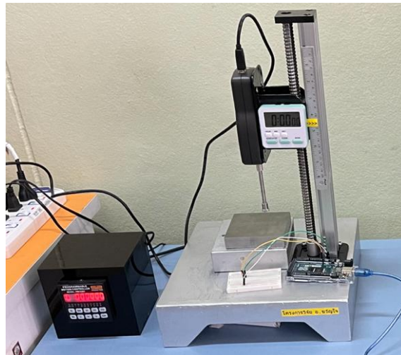
รูปที่ 3 เครื่องกชมาตรฐาน (Digital Force Gauge) รุ่น DFG50
