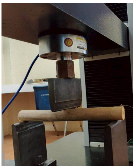
รูปที่ 3 การทดสอบมอดูลัสแตกหักและมอดูลัสยืดหยุ่นด้วยเครื่องทดสอบสากล
