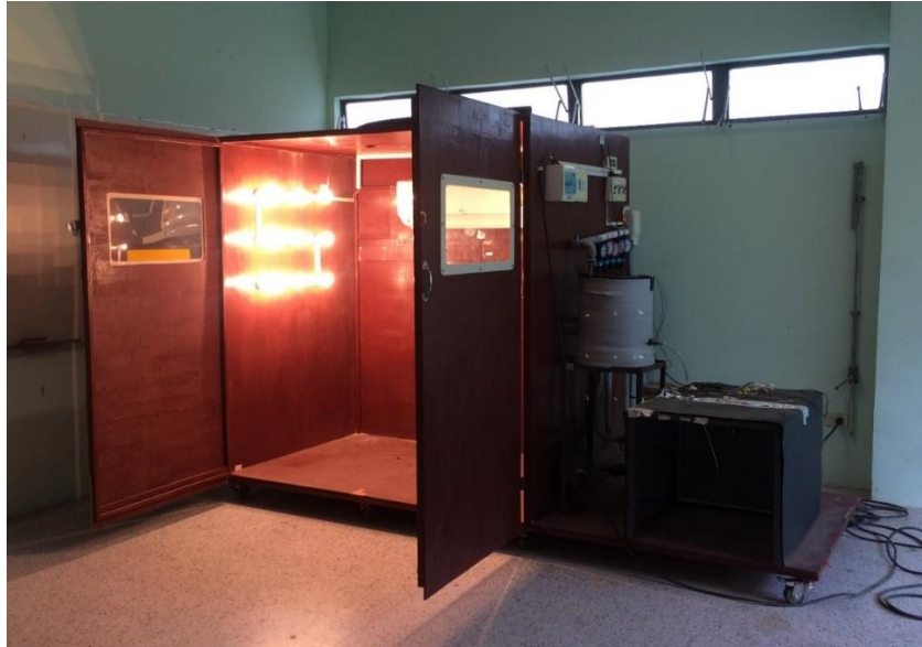
รูปที่ 1 ระบบปรับอากาศที่ติดตั้งถังกักเก็บพลังงานความเย็น
