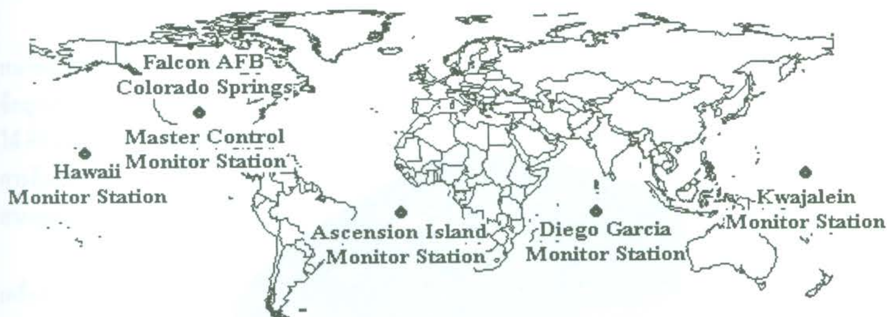
รูปที่ 3 แสดงสถานีควบคุมแม่ข่าย 1 สถานี และสถานีควบคุมลูกข่าย 4 สถานี
