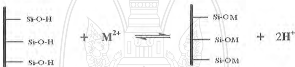
รูปที่ 2 ภาพแสดงการดูดซับแบบแลกเปลี่ยนไอออนระหว่างโลหะไอออนกับวัสดุตามทฤษฎี
