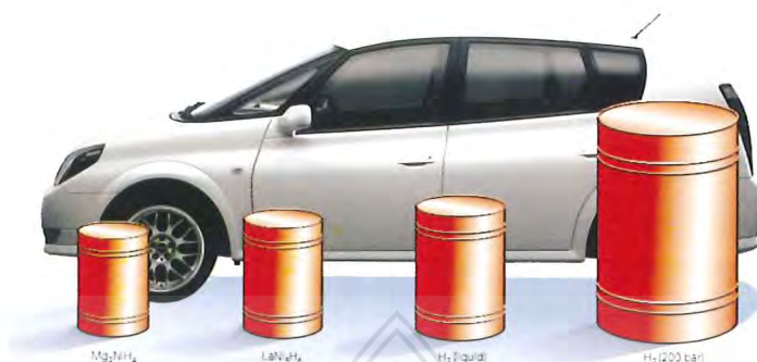
รูปที่ 3 ขนาดของภาชนะแบบต่างๆ ที่ใช้สำหรับบรรจุไฮโดรเจนปริมาณ 4 กิโลกรัมเมื่อเทียบกับขนาดของรถยนต์ (ที่มา: Schlapbach and Züttel, 2002)
