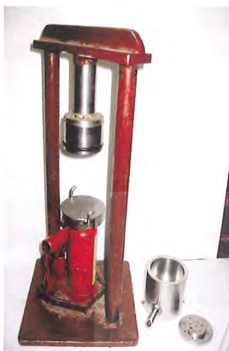
รูปที่ 1 เครื่องมือบีบผลปาล์มน้ำมัน
