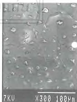
รูปที่ 10 ฟิล์มไคโตซานที่บรรจุอนุภาคไมโครของพอลิ(ดี,แอล-แลคไทด์-โค-ไกลโคไลด์) ที่บรรจุยาอิพริฟลาโวนภายในอนุภาค (ที่มาของภาพ Perugini et al. , 2003)
