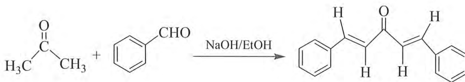
รูปที่ 1 การเตรียม dibenzalacetone
