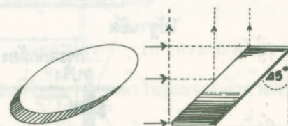
กระຈกเอียง (DIAGONAL OR ELLIPTICAL MIRROR)
