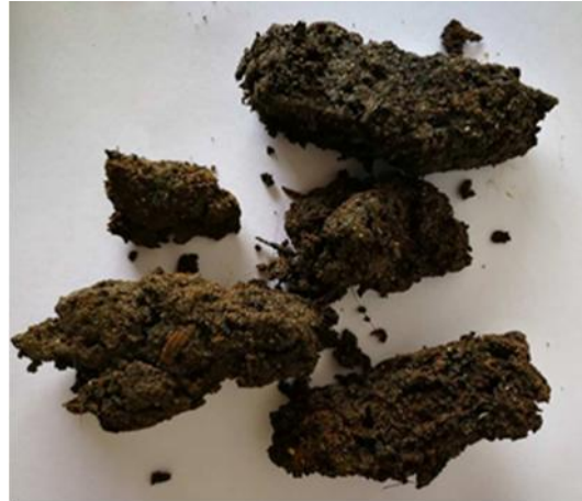
รูปที่ 7 ชิ้นงานวัสดุผสมระหว่างศิลาแลงและเยื่อแฟกที่อัตราส่วน 30:70 หลังจากฝังดินเป็นเวลา 90 วัน
