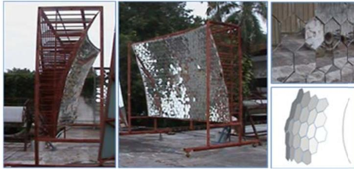
**รูปที่ 3** รูปของงานรวมแสงเดิมที่เป็นแบบพาราโบล่าไฟก้านนอกแกน แสงโครงสร้างเหล็ก และแผ่นกระจกที่เริ่มแตกและบางส่วนหลุดออก
