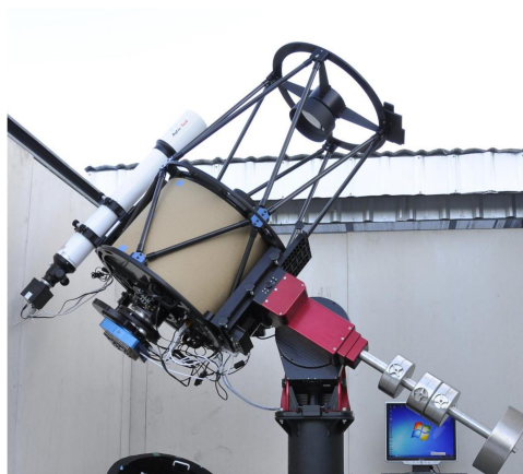
รูปที่ 1 กล้องโทรทรรศน์สะท้อนแสงชนิด ริทชี - ครีเตียง ขนาดเส้นผ่านศูนย์กลาง 0.5 เมตร
