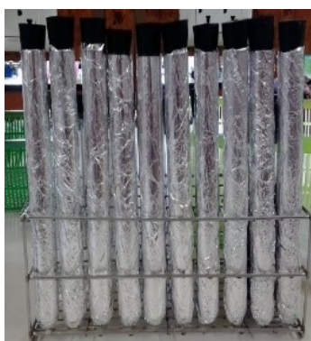
รูปที่ 6 การเตรียมหลอดทดลองสำหรับการทดสอบการลดกลิ่น
