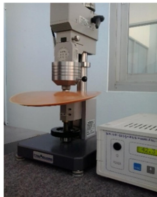
รูปที่ 9 รูปแสดงการทดสอบความแข็งของยาง
