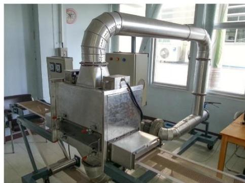
รูปที่ 6 เครื่องอบแห้งด้วยไมโครเวฟร่วมกับลมร้อนแบบสายพานลำเลียงต้นแบบ
