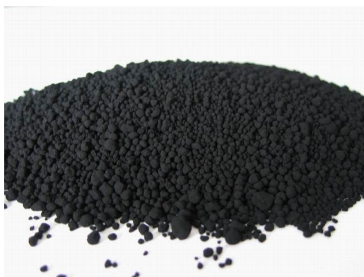
รูปที่ 5 เม็ดเขม่าดำ (Tokai carbon company, 2015)
