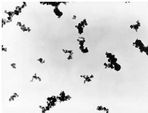
รูปที่ 1 สารตัวเติมเสริมแรงในยางหลังการผสมในเครื่องผสมแบบปิด (Dick, 2001)
