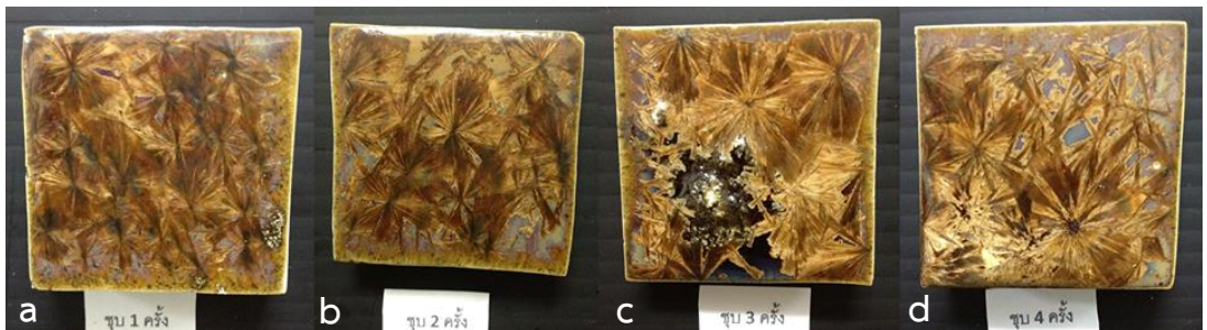
รูปที่ 13 เคลือบสูตรที่ 3 ซุบเคลือบ (a) 1 ครั้ง (b) 2 ครั้ง (c) 3 ครั้ง และ (d) 4 ครั้ง ครั่งละ 5 วินาที หลังจากซุบเคลือบแล้วเผาด้วยรูปแบบที่ 3
