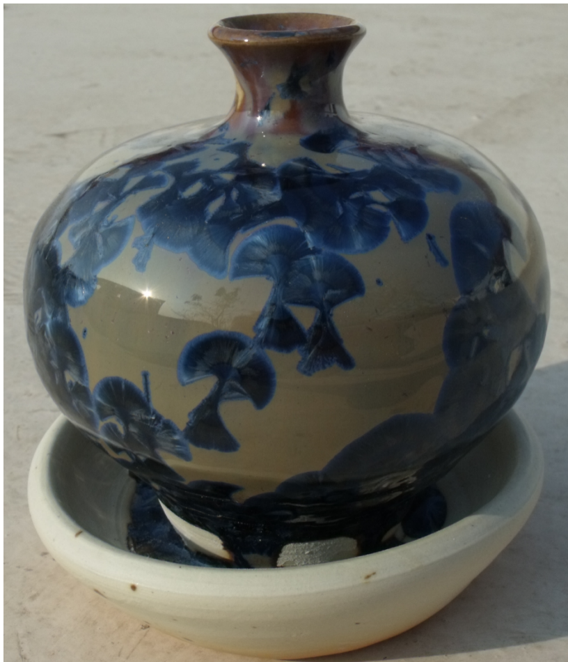
รูปที่ 15 ชิ้นงานเคลือบด้วยเคลือบสูตรที่ 1 ซุบเคลือบ 3 ครั้ง เผาด้วยรูปแบบที่ 3
