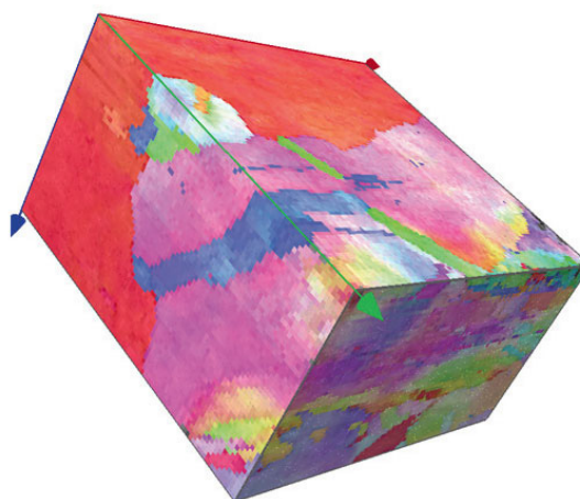
รูปที่ 6 แผนภาพ 3 มิติของทิศการวางตัว (3D orientation map) ของ Cu (Oxford Instruments., 2013)
