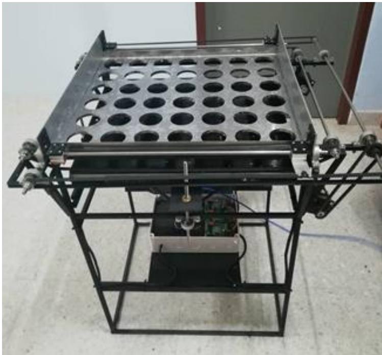
ภาพที่ 5 เครื่องพิมพ์ขึ้นรูปข้าวแตนต้นแบบ
