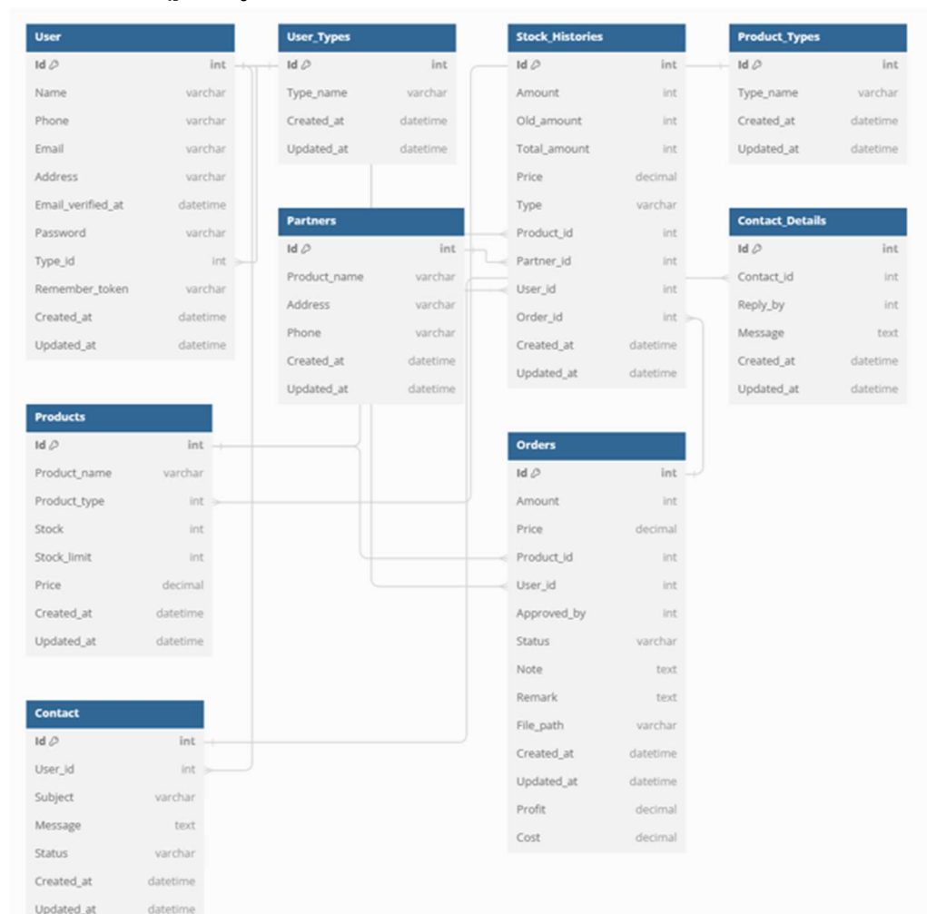
ภาพที่ 5 แผนภาพแสดงความสัมพันธ์ของข้อมูล (Entity Relationship Diagram)
