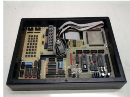
รูปที่ 1 ชุดทดลองการเขียนโปรแกรมภาษาซีด้วย SDCC บน MCS-51
