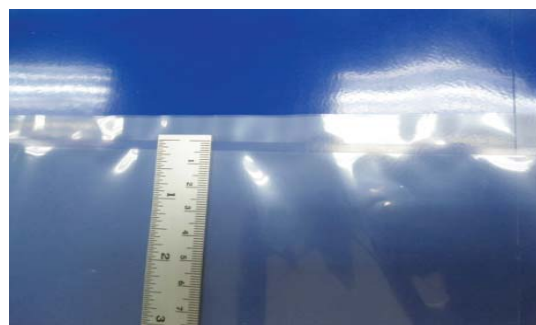
รูปที่ 4 การตรวจสอบรอยปิดผนึก
