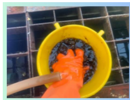
รูปที่ 4 การกรองแยกเยื่อจากน้ำโซดาไฟ
