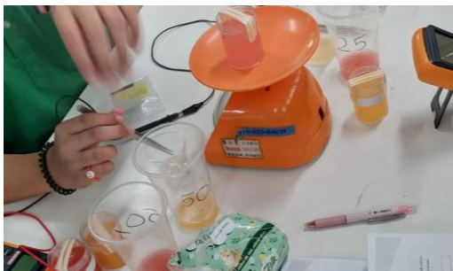
รูปที่ 4 นักเรียนปฏิบัติการทดลองสร้างแบบจำลองเซลล์ไฟฟ้าเคมีจากน้ำผลไม้ที่มีความเข้มข้นต่างกัน
