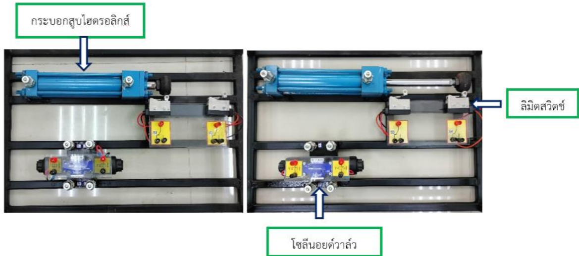
รูปที่ 3 ชุดกระบอกลูกสูบไฮดรอลิกส์และโซลินอยด์วาล์ว
