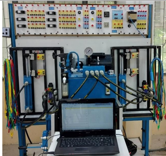
รูปที่ 1 ชุดฝึกไฮดรอลิกส์ควบคุมด้วยไฟฟ้าและโปรแกรมเมเบิลลอจิกคอนโทรลเลอร์
