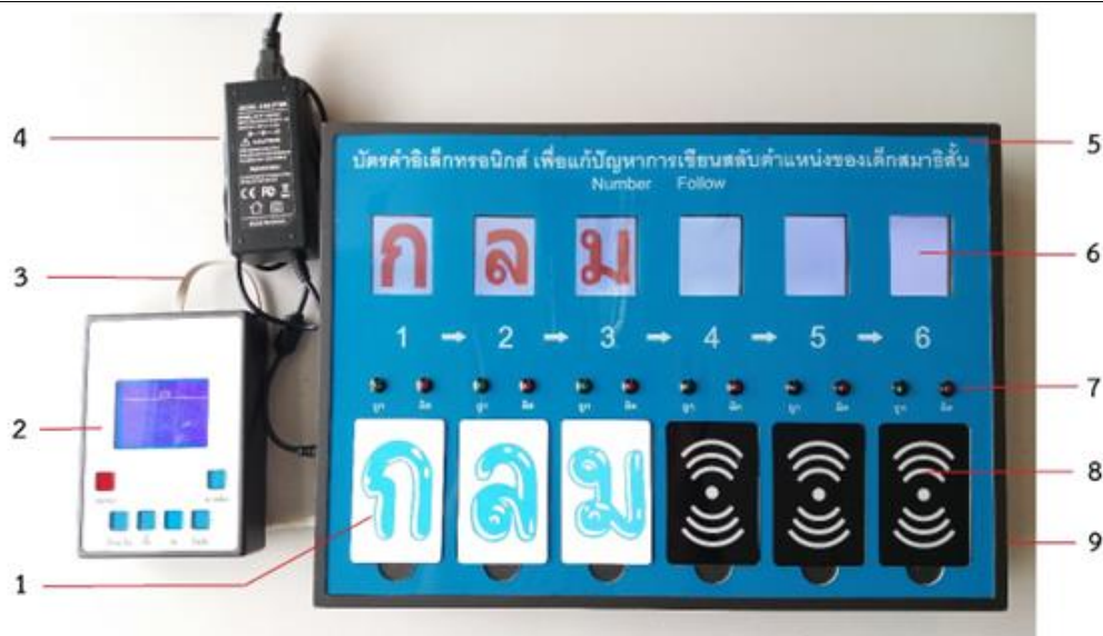
1 บัตรอักขระ 2 กล้องรายการคำศัพท์ 3 สาย RJ11 4 แหล่งจ่ายไฟฟ้ากระแสตรง 5 เครื่องอ่านคำศัพท์อิเล็กทรอนิกส์ 6 จอแสดงผล 7 ไฟแสดงผล 8 แป้นวางบัตรอักขระ 9 ลำโพง
