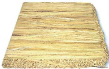
รูปที่ 11 แผ่นวัสดุจากการอัดด้วยเครื่องอัดร้อนโดยใช้หญ้าปัดฉิว
