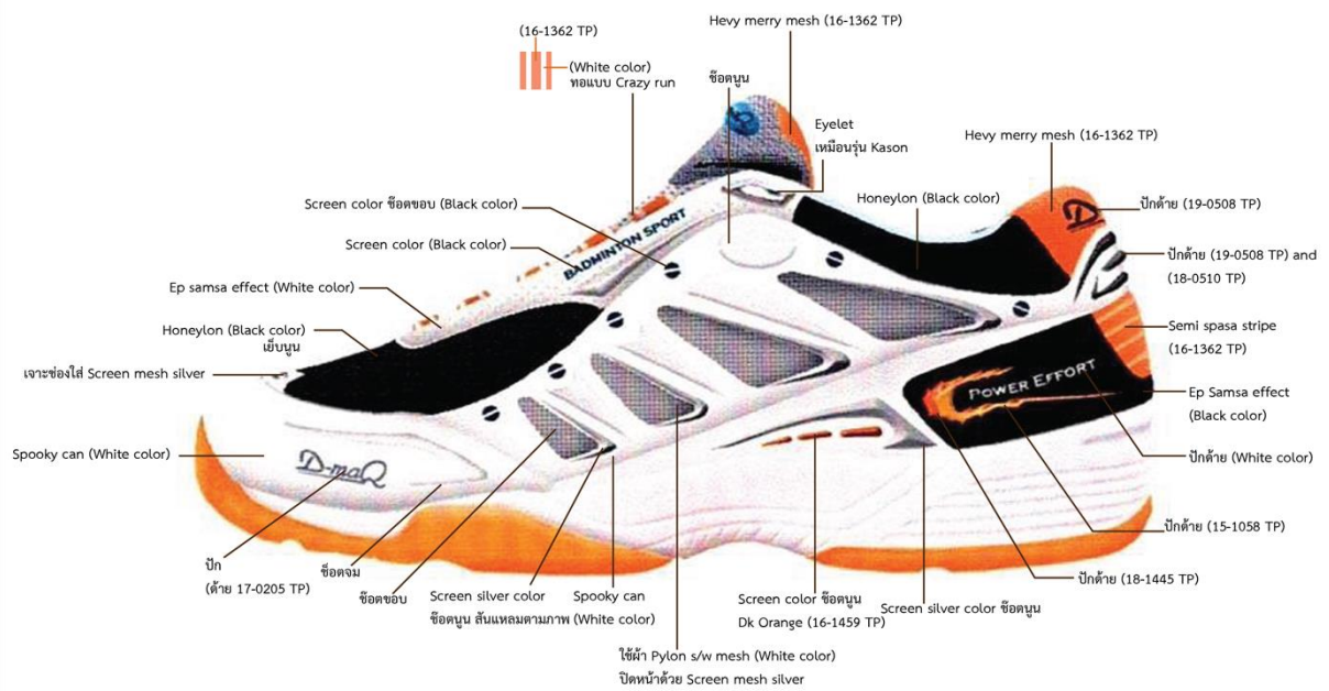
รูปที่ 14 แสดงการใส่รายละเอียด วัสดุ กระบวนการผลิตให้กับโรงงานผู้ผลิต [8]
