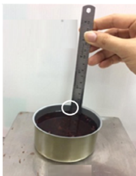
รูปที่ 1 ช่องว่างเหนืออาหาร (Headspace) ของโถงข้าวไรซ์เบอร์รี่บรรจุกระป๋อง
