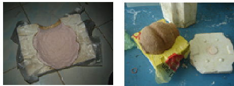
รูปที่ 9 คลุกเคล้าเยื่อไม้กับกาวประสาน
