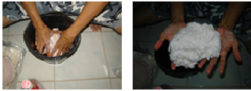
รูปที่ 8 คลุกเคล้าเยื่อไม้กับกาวประสาน
