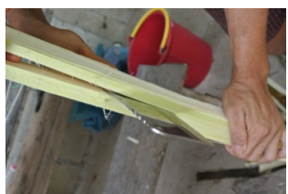
รูปที่ 3 การตัดแบ่งทางปาล์มน้ำมันเพื่อง่ายต่อการรีดเส้นใย
