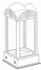
รูปที่ 4 อุปกรณ์ติดตั้งทำด้วยไม้สักฉลุสลักรายแรงบันดาลใจจากมงกุฎพร้อมไฟส่องสว่างด้านบน ฐานหมุนได้มีเพลงบรรเลง 18 ตัวโน้ต
