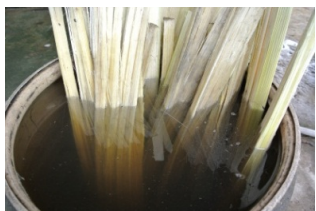
รูปที่ 4 แช่น้ำเปล่าให้เนื้อเยื่ออ่อนตัวเพื่อง่ายต่อการลอกเส้นใย
