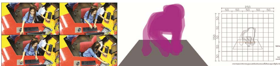
รูปที่ 1 แสดงการทดสอบด้วยวิธีการทดสอบการเคลื่อนไหวของร่างกาย (Body Envelope Motion, BME) และใช้โปรแกรมคอมพิวเตอร์ในการแปลงค่า เพื่อหาขนาดระยะขอบเขตพื้นที่สูงสุดในแต่ละกิจกรรมบนรูปแบบเฟอร์นิเจอร์
