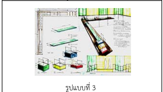
รูปที่ 3 ผู้วิจัยได้ออกแบบร่างอุปกรณ์เสริมทักษะด้านการเคลื่อนไหวกล้ามเนื้อใหญ่ สำหรับเด็กบกพร่องทางสติปัญญา จำนวน 3 รูปแบบ โดยรูปแบบที่ 1 ได้แนวคิดมาจากรูปทรงของตัวอักษรในภาษาอังกฤษ รูปแบบที่ 2 ได้แนวคิดมาจากท่อนโดยการใช้อุปกรณ์สี่เหลี่ยมนำมาจัดเรียงให้มีลักษณะเหมือนท่อนและรูปแบบที่ 3 ได้แนวคิดมาจากการรูปทรงตัวแอล
