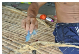
รูปที่ 8 การแยกเส้นใยออกจากส่วนเยื่อหุ้มให้เป็นเส้นใยขนาดเล็ก
