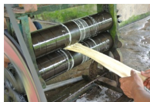
รูปที่ 6 ใช้เครื่องรียางแผ่นเพื่อรีดเส้นใย
