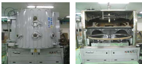
รูปที่ 3 เครื่องเคลือบระบบสุญญากาศด้วยวิธีระเหยสารที่ใช้ในงานวิจัย
