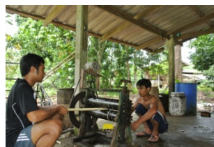
รูปที่ 7 การรีดเส้นใยกับเยื่อโปรตีนแยกออกจากกัน
