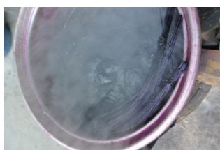
รูปที่ 11 การแช่เส้นใยในน้ำต้มสีจนสังเกตเห็นสีของเส้นใยปาล์มน้ำมันที่เปลี่ยนเงา (5 นาที)
