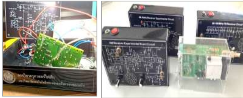
รูปที่ 3 การพัฒนาชุดทดลองเครื่องรับส่งวิทยุ AM และ FM
