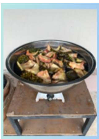
รูปที่ 3 การต้มเปลือกทุเรียนผสมโซดาไฟหรือน้ำด่างซี้
