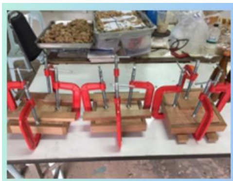
รูปที่ 9 การทดลองขึ้นรูปแผ่นขึ้นไม้อัดจากเปลือกทุเรียน
