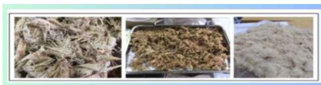
รูปที่ 7 ลักษณะเยื่อแห้งจากเปลือกทุเรียนขนาดต่าง ๆ ที่พร้อมสำหรับการเก็บไว้ใช้งานต่อไป
