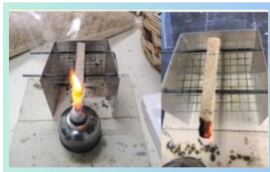
รูปที่ 13 ภาพการทดสอบอัตราการเผาไหม้แผ่นชั้นไม้อัดจากเปลือกทุเรียน
