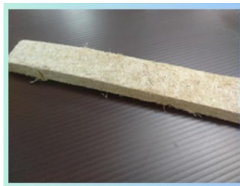
รูปที่ 10 แผ่นวัสดุจากกระบวนการขึ้นรูปแบบกดอัด (Mold compressing)
