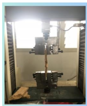
รูปที่ 12 ภาพการทดสอบการดึง (Tensile test)
