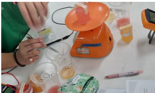
รูปที่ 4 นักเรียนปฏิบัติกรทดลองสร้างแบบจำลองเซลล์ไฟฟ้าเคมีจากน้ำผลไม้ที่มีความเข้มข้นต่างกัน
