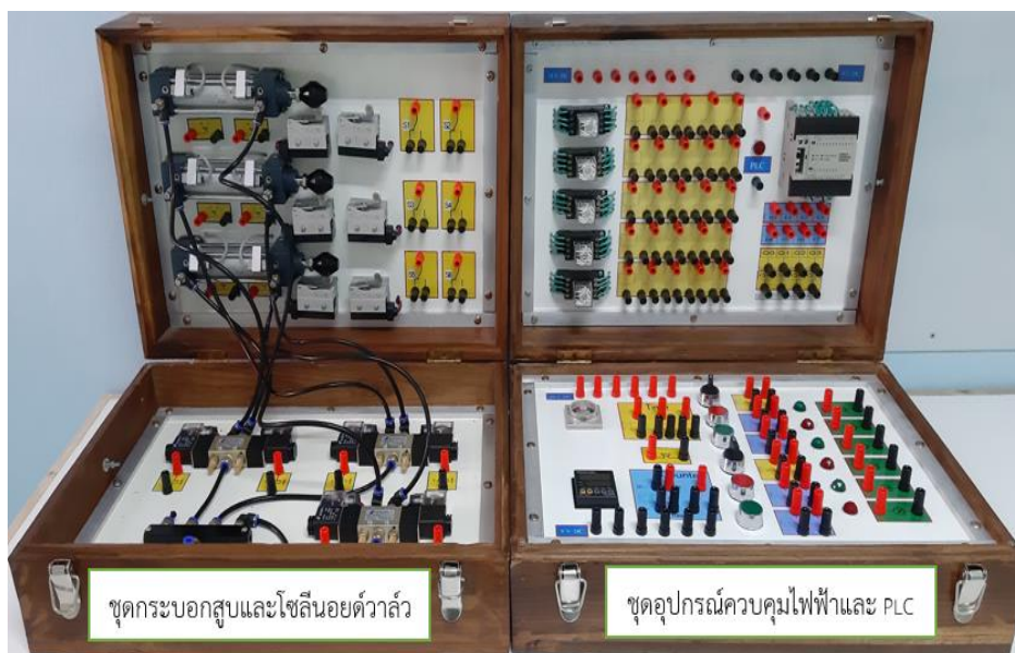
รูปที่ 1 ชุดฝึกนิวแมติกส์ควบคุมด้วยไฟฟ้าและ PLC
