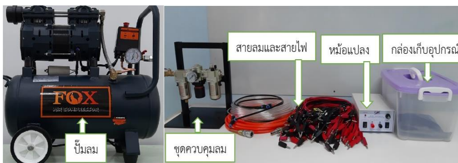
รูปที่ 6 ชุดปั๊มลมและหม้อแปลง
