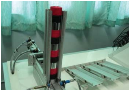
รูปที่ 2 แสดงชิ้นงาน 3 สี ถูกบรรจุไว้ที่ชุดจ่ายชิ้นงาน
