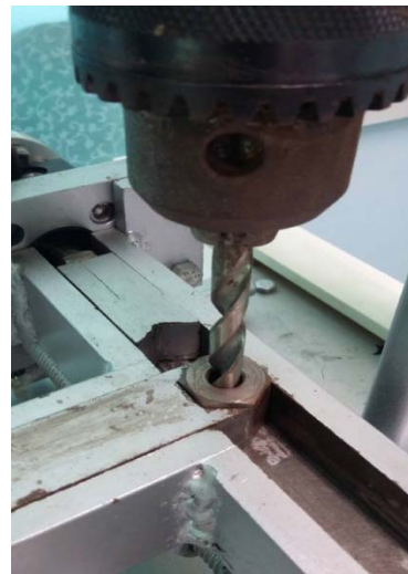
รูปที่ 5 แสดงชิ้นงานที่กำลังถูกเจาะ
