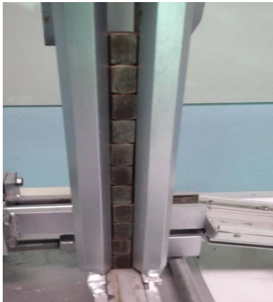
รูปที่ 2 แสดงชิ้นงานจะถูกบรรจุไว้ที่ชุดเก็บชิ้นงาน
