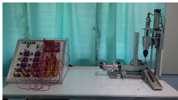
รูปที่ 1 แสดงชุดฝึกแมคคาทรอนิกส์เครื่องเจาะชิ้นงานอัตโนมัติ
