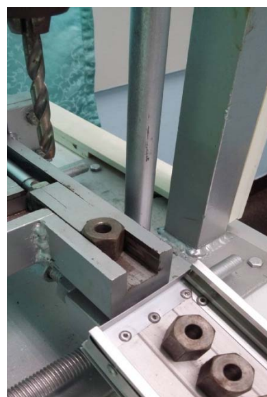
รูปที่ 6 แสดงชิ้นงานที่เจาะแล้วถูกผลักออกไปที่เก็บชิ้นงาน
