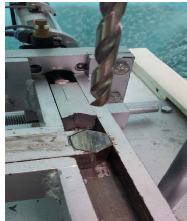
รูปที่ 4 แสดงชิ้นงานที่ถูกจับยึดด้วยกระบอกสูบ
