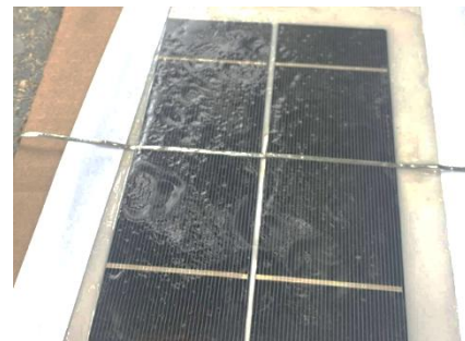
รูปที่ 4 แสดงการเคลือบผิวแผงโซลาร์เซลล์ด้วยเรซิน
