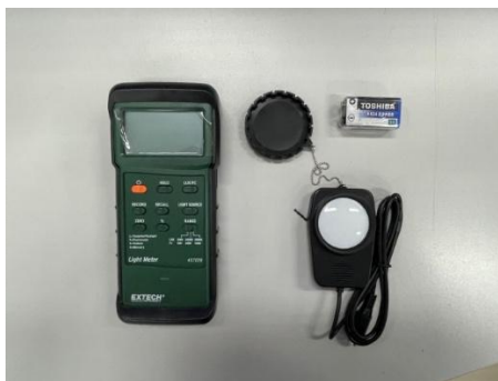
รูปที่ 1 เครื่องวัดแสง (Lux Meter) รุ่น EXTECH รุ่น 407026
