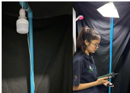
รูปที่ 4 การติดตั้งหลอดไฟและการทดลองการตรวจวัดประเมินความเข้มของแสงสว่างของวัสดุฝ้าครอบหลอดไฟ
