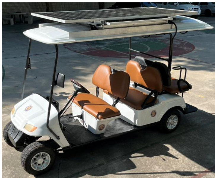
รูปที่ 5 แสดงชุดอุปกรณ์ต้นแบบที่ติดตั้งบนหลังคาของรถกอล์ฟไฟฟ้า 6 ที่นั่ง
