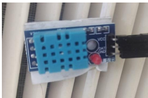
รูปที่ 3 เซ็นเซอร์ควบคุมอุณหภูมิและความชื้นเครื่องปรับอากาศแบบแยกส่วน
